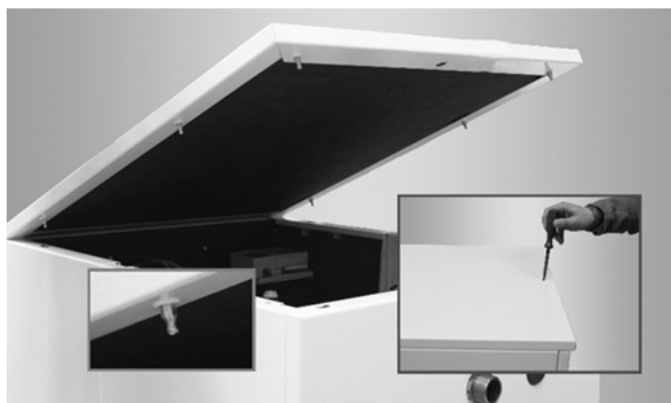
Abb. 58: Demontage der oberen Verkleidung
