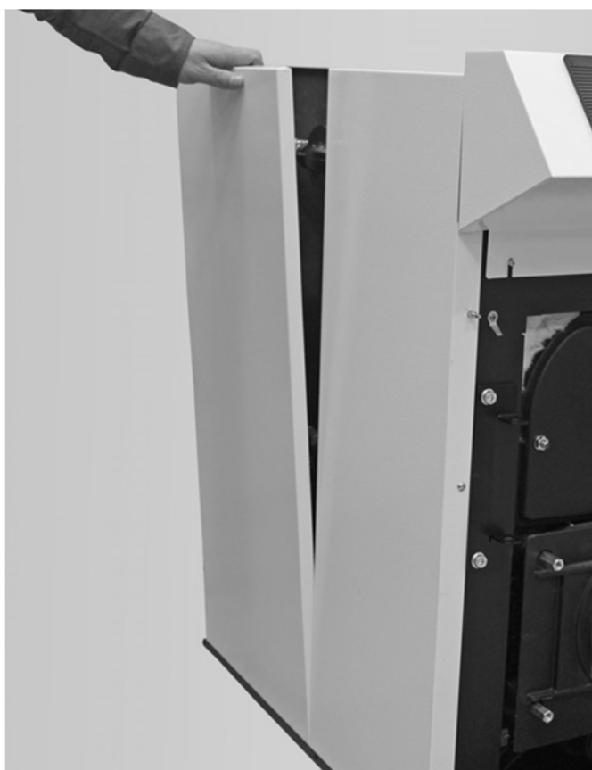
Abb. 61: Demontage der seitlichen Verkleidung
