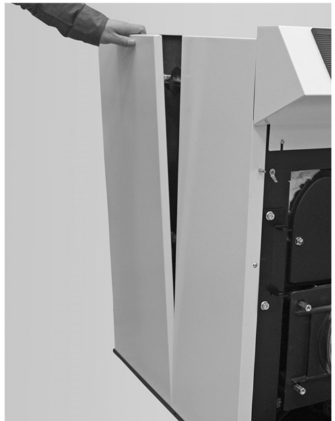
Abb. 6: Demontage der seitlichen Verkleidung
