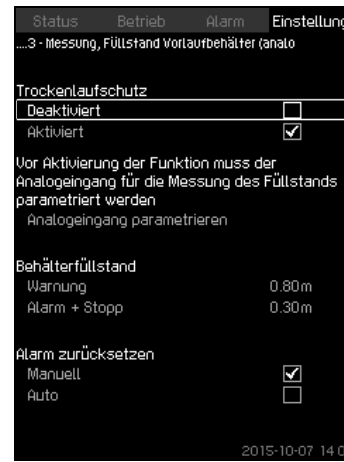
Abb. 98 Messung, Füllstand Vorlaufbehälter (analog)
