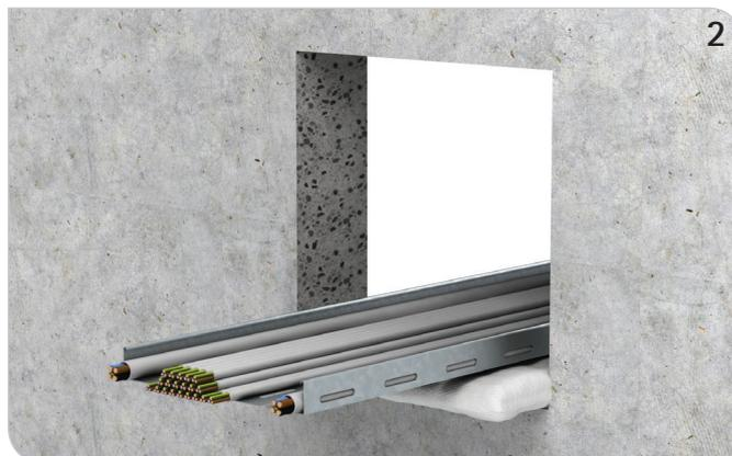
Nach Möglichkeit die erste Lage Pacifyre® IWC Brandschutzkissen unter die Kabeltrasse oder das Kabelbündel platzieren.
