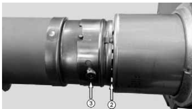
Abb. 4: Einstellung Rezirkulationsmaß R ② (Abbildung beispielhaft)
