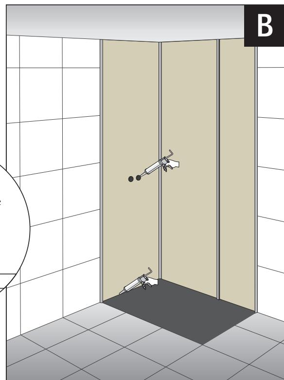
Dichten Sie die Übergänge von Wand zu Boden mit Silikon ab. Versiegeln Sie die Leerräume um die Anschlüsse mit Silikon.
