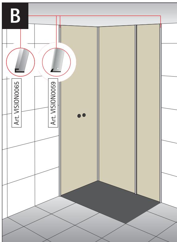
Schieben Sie auf die letzte Platte die Abschlusskante, schräg (Art. VISION0059) bzw. die Abschlusskante, gerade (Art. VISION0065), und bringen Sie diese an der mit Kleberaupen vorbereiteten Wand an. Drücken Sie die Platte gleichmäßig an.
