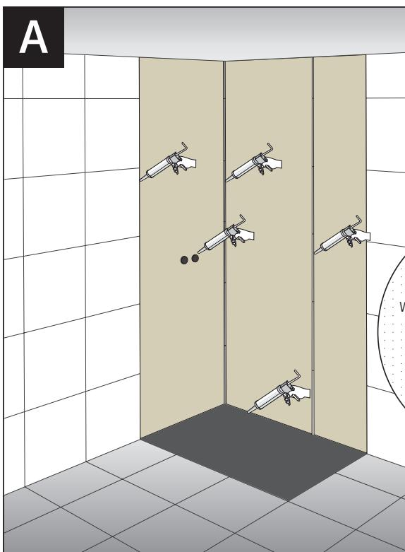
Dichten Sie die Übergänge von Wand zu Boden mit Silikon ab. Versiegeln Sie die Leerräume um die Anschlüsse mit Silikon. Zur Abdichtung der Außen- und Stoßkanten empfiehlt sich ebenfalls eine Silikonverfügung über sämtliche offenliegende Kanten hinweg, um eine Feuchteunterwandung sowie Schmutz, Staunässe und Schimmel zu vermeiden.
