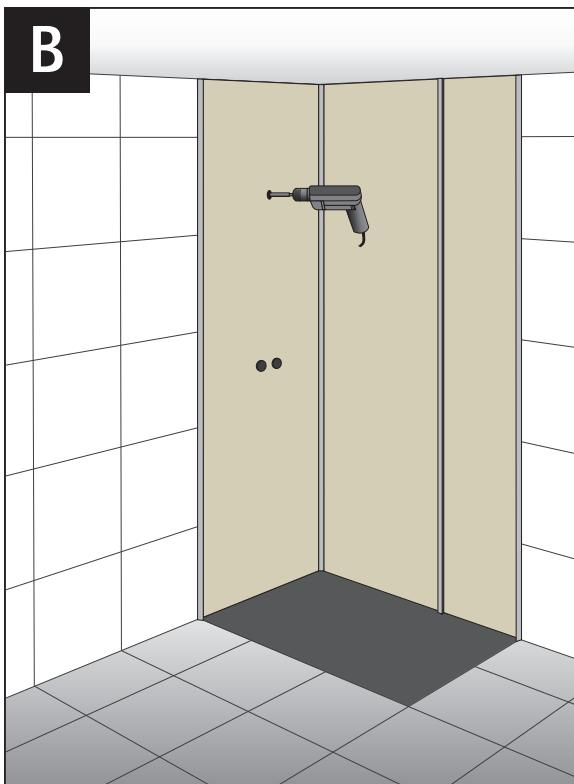
Für die Bohrungen durch das Glaslaminat zum Anbringen von Duschstange, Duschkabine etc. verwenden Sie einen Metallbohrer. Bohren Sie immer 1 mm größer als die zum Einsatz kommenden Dübel. Anschließend wird der dem Untergrund entsprechende Bohrer verwendet.
