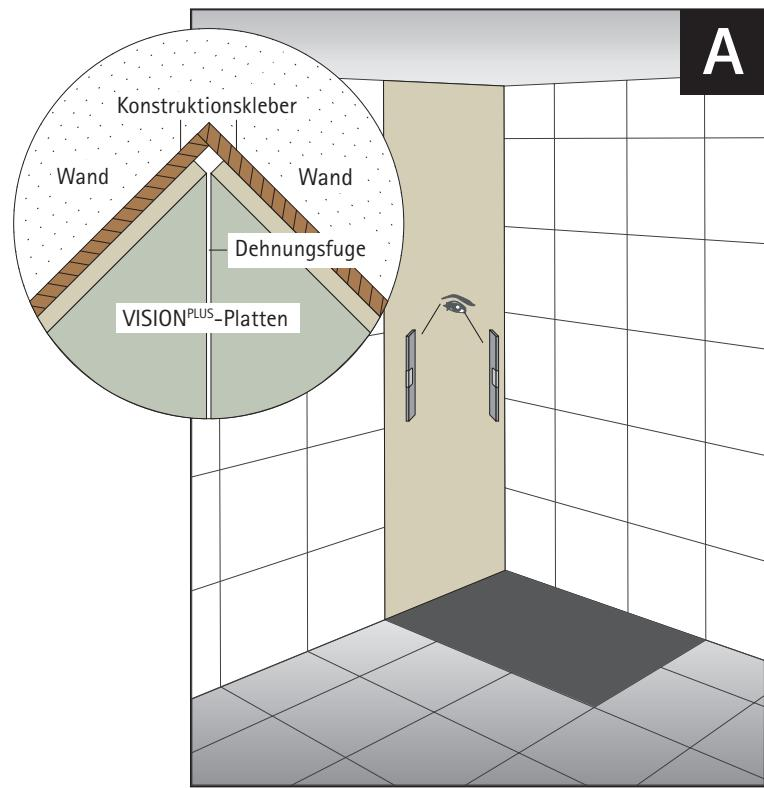
Platzieren Sie die MULTISTAR® VISIONPLUS-Platte an der Wand und drücken Sie diese gleichmäßig an.
