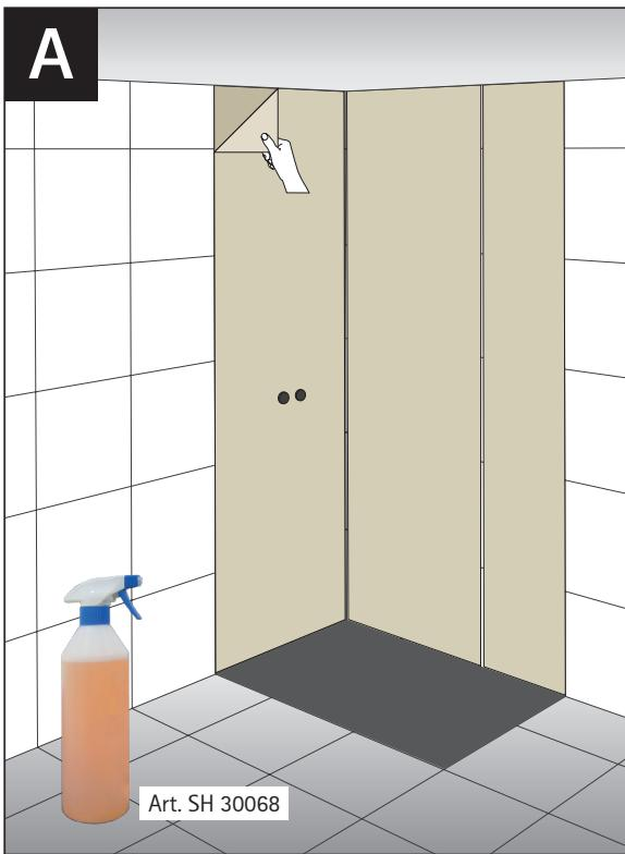
Bringen Sie die weiteren Platten auf der mit Kleberaupen vorbereiteten Wand unter Beachtung der entsprechenden Dehnungsfugen an. Entfernen Sie die Schutzfolie und reinigen Sie die Platten abschließend mit unserem Oberflächenreiniger für Glaslaminat (Art. SH 30068).
