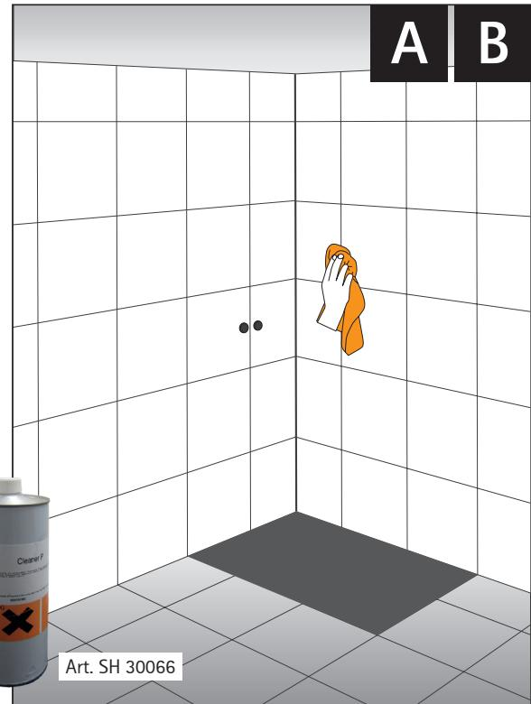
Überprüfen Sie vor der Montage der MULTISTAR® VISION<sup>PLUS</sup>-Platte, ob die Wände gerade sind. Prüfen Sie diagonal mit einer langen Wasserwaage oder Richtscheit (2 m). Toleranzen > 5 mm müssen vor der Montage ausgeglichen werden.
