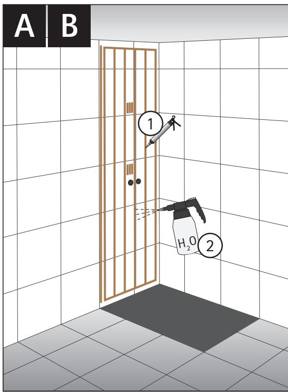
Setzen Sie die Kleberaupen für die Platten vertikal im Abstand von ca. 50 mm auf die Wand.
