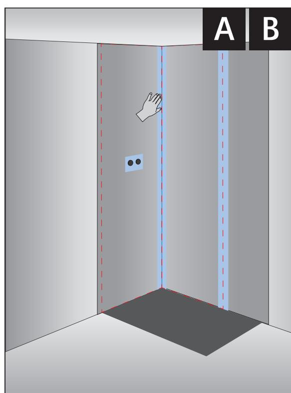
Bringen Sie an den Übergangsstellen selbstklebendes Dichtband (Art. SH 30069) an.
