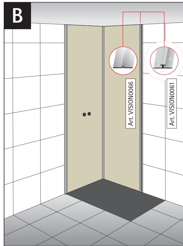
Tragen Sie auf das Trennprofil Silikon auf, schieben Sie das Trennprofil (Art. VISION0061 oder VISION0066) auf die nächste MULTISTAR® VISION<sup>PLUS</sup>-Platte und bringen Sie diese an der mit Kleberaupen vorbereiteten Wand an. Drücken Sie die Platte gleichmäßig an.
