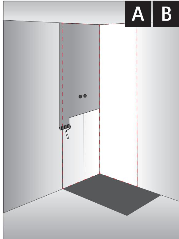
Bitte prüfen Sie vor der Montage der MULTISTAR® VISION<sup>PLUS</sup>-Platten die bautechnischen Voraussetzungen: Die Wände müssen gerade sein, der Untergrund fest, tragfähig und trocken. Prüfen Sie die Wände diagonal mit einer langen Wasserwaage oder einem Richtscheit (2 m). Toleranzen > 5 mm müssen vor der Montage ausgeglichen werden.
