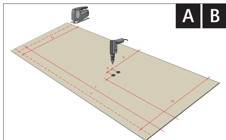
Zeichnen Sie die Abgrenzung der Platten an der Wand an. Übertragen Sie die Maße auf die Platte und schneiden Sie die Platte zu. Berücksichtigen Sie beim Ausmessen die Dehnungsfugen zwischen den Platten. Bohren Sie Löcher für die Anschlüsse. Die Platten können mit allen gängigen Holzbearbeitungswerkzeugen bearbeitet werden. Späne immer von der Platte absaugen bzw. abkehren. Arbeiten Sie immer auf der Sichtfläche der Platte. Achten Sie auf eine gute Auflage der Platte. **Vorsicht Bruchgefahr!**
