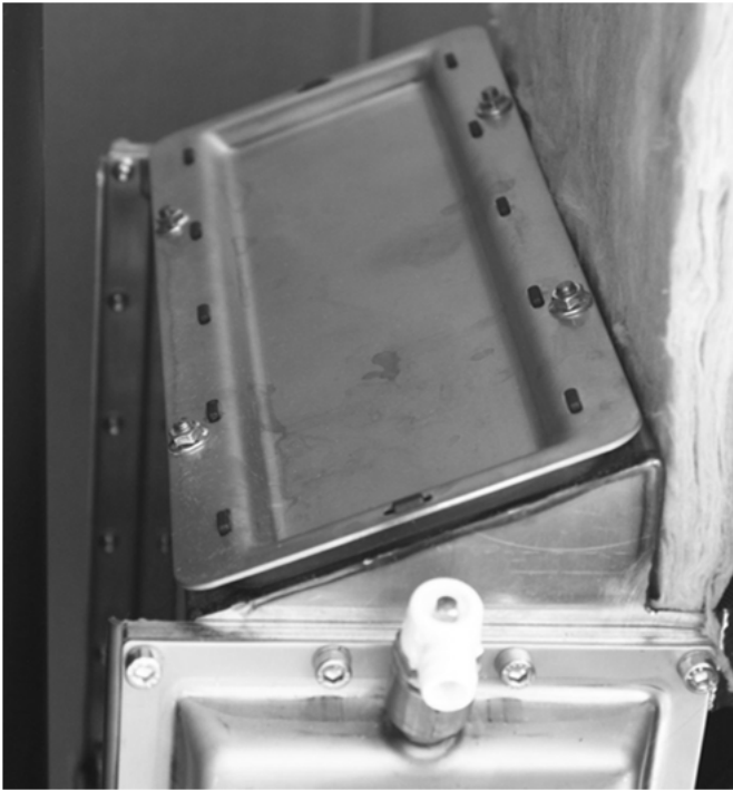
Abb. 51: Reinigungsklappe des GWT
