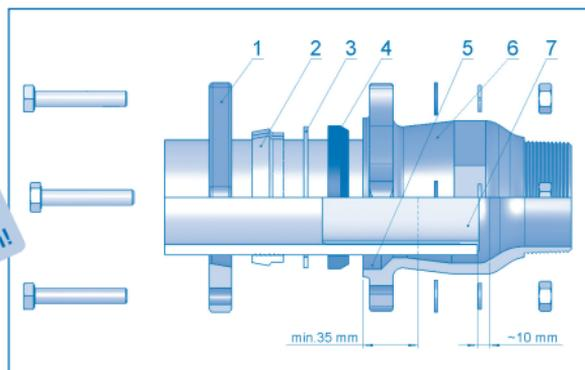
**D** \*Einbaulänge beachten! Rohre dürfen nicht bis zum Anschlag eingeführt werden bzw. bei Kupplungen nicht aneinander stoßen
