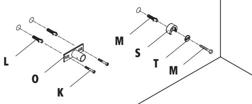
**11 Heizkörperbefestigungen montieren (Maße siehe Tabelle Technische Daten und Abbildung Bohrabstände)**
