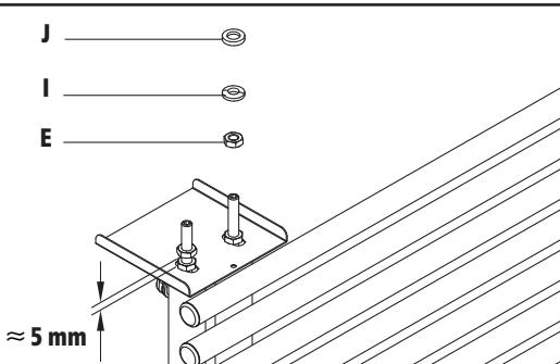
**12 Sechskantmuttern DIN 936 (E) links und rechts mit ca. 5 mm Spielraum zur unteren Schraube auf die Gewindestifte M8x60 (G) aufdrehen.**
