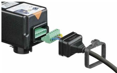
Die elektrische Verbindung des Motors erfolgt durch ein externes System Steckdose/Stecker, ohne die Abdeckung entfernen zu müssen. Nach dem Einstecken des Steckers die Schutzkappe aus Gummi in ihren Sitz, d.h. in die entsprechende Nut im Deckel, gleiten lassen. Danach muss die Schutzkappe wie in dem Bild befestigt werden und mit Schraubenzieher angezogen werden. Die folgenden Schemen zeigen die gebräuchlichen elektrischen Anschlüsse:
