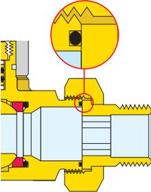
Le valvole sono dotate di bocchettoni con O-Ring di tenuta in EPDM.
