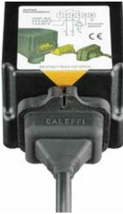
La conexión eléctrica del motorreductor se realiza con un sistema toma-clavija, exterior, que no requiere la apertura de la tapa. Con la clavija conectada, deslice la tuerca de protección en caucho, insertándola en el asiento en la ranura correspondiente de la tapa sucesivamente fijar la protección con la banda estrecha en dotación y, como en la imagen, apretar con un destornillador. Los siguientes esquemas ilustran las conexiones eléctricas normalmente adoptadas:
