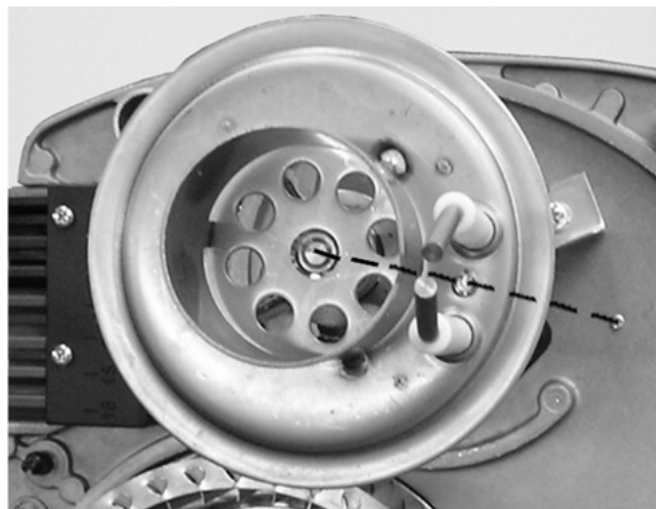
Abb. 25: Mischsystempositionierung und Ausrichtung Zündelektrode
