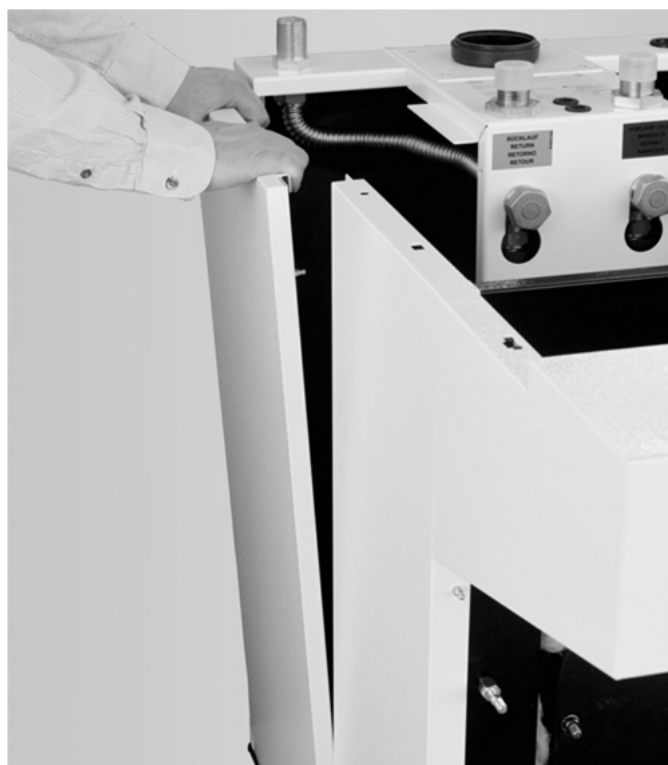
Abb. 45: Demontage der seitlichen Verkleidung
