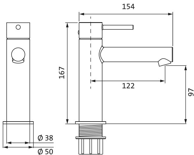
Lochbohrung Ø 35 mm
