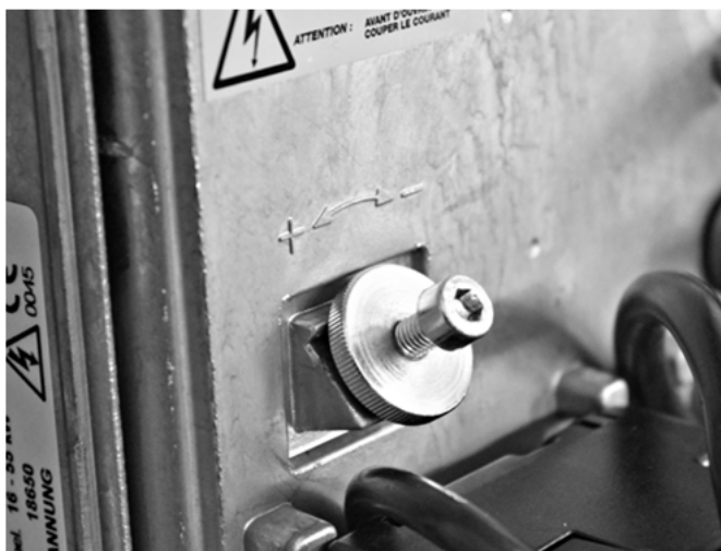
Abb. 8: Verstellerschraube der Luftklappe
