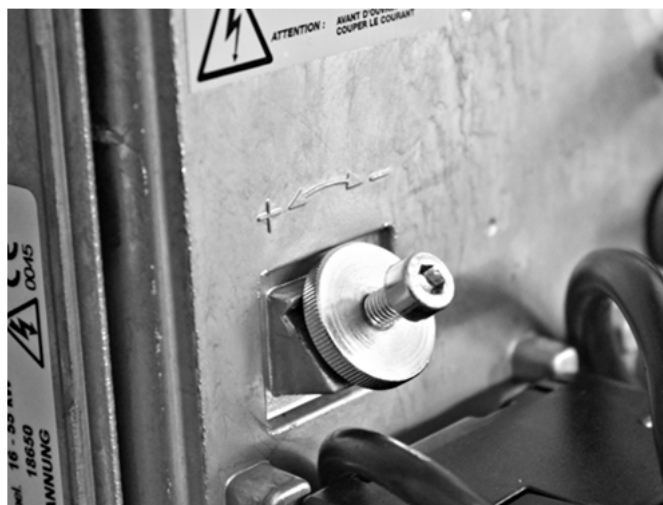
Abb. 8: Verstellerschraube der Luftklappe
