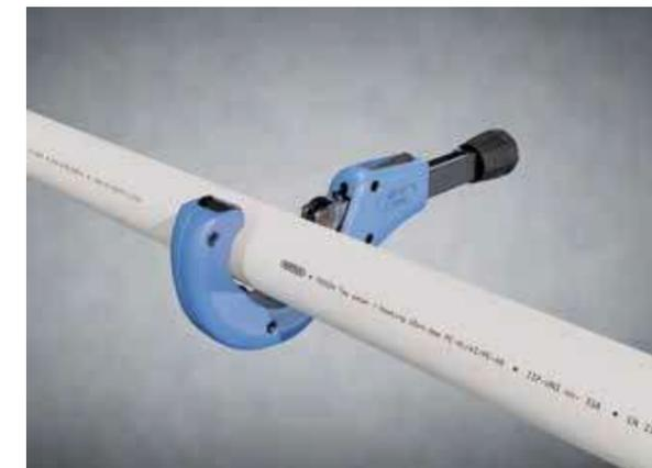
Abb.: Ablängen mit Wavin Rohrschneider
