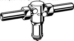
Geeignete Elektrode auswählen. Werkstoff der Anschweißenden ST35.29 DIN 2448
