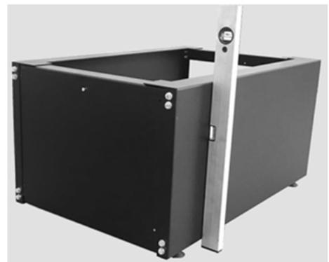
Abb./Fig. 7: Prüfung der Seitenbleche
