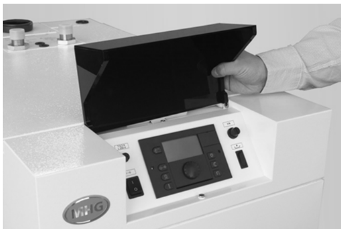
Abb. 40: Demontage der Abdeckung Bedienfeld
