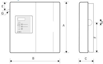
460 A Höhe [mm] B Breite [mm] 460 C Tiefe [mm] 210 D Notüberlauf DN 70 E [mm] 120 F [mm] 265 G Trinkwasser 3/4" Saugseite 1" AG
