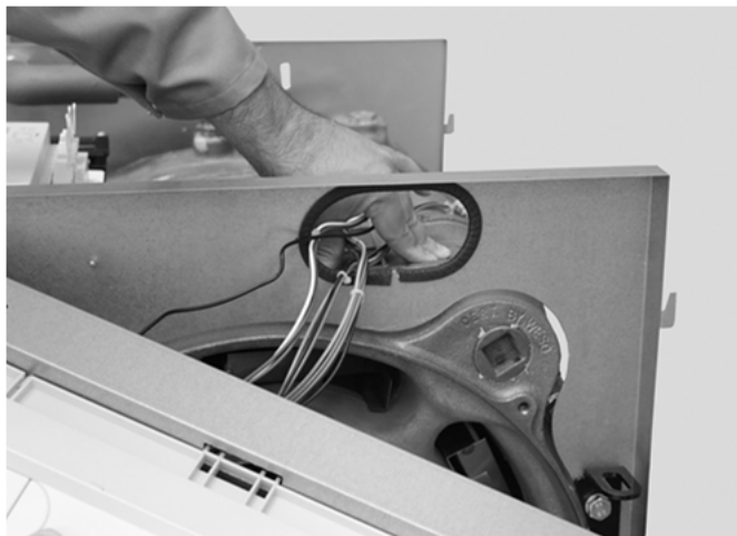
Abb. 40: Einstecken des Kabelbaums durch die Öffnung im Verkleidungsblech
