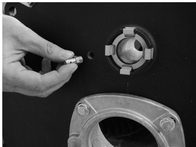
Abb. 48: Einschrauben des Druckmessnippels
