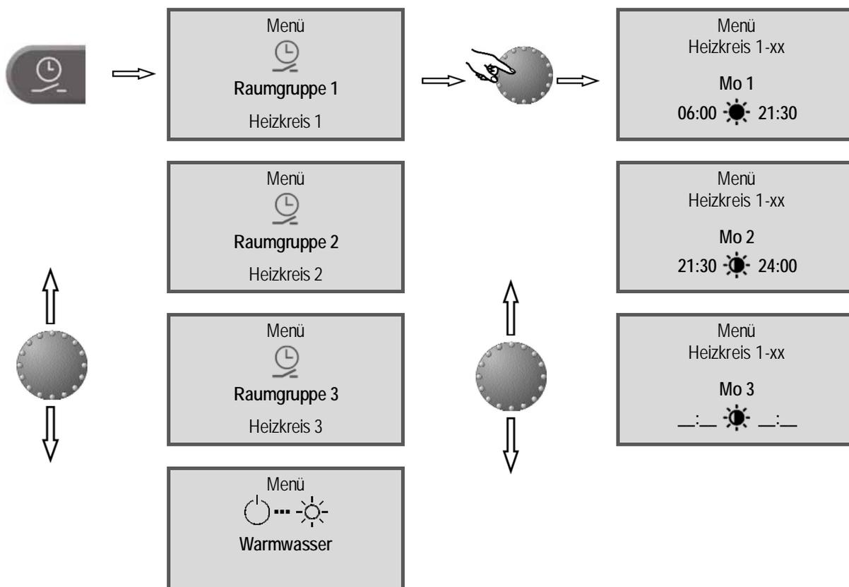
Im Menü "Schaltzeiten" können für jede Raumgruppe (Heizkreis) und die Warmwasserbereitung individuelle Schaltzyklen programmiert werden. Zur Programmierung der Schaltzeiten stehen für jeden Wochentag maximal drei Schaltzyklen mit je einer Ein- und Ausschaltzeit zur Verfügung. Es kann zwischen Wohlfühl- ☀️ und Spartemperatur 🌑 gewählt werden.
