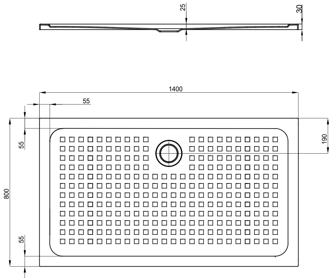
FORMAT Design Mineralguss Duschwanne mit Antirutsch 1400x800
