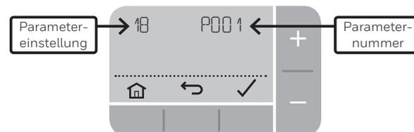
Drücken Sie die Tasten und um durch die Parameterliste zu navigieren. Drücken Sie die Taste um einen Parameter zu ändern und zu speichern. Drücken Sie die Taste um das Menü zu verlassen.
