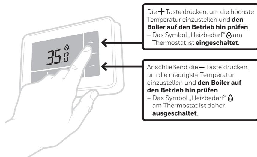
Die **+** Taste drücken, um die höchste Temperatur einzustellen und **den Boiler auf den Betrieb hin prüfen** – Das Symbol „Heizbedarf“ am Thermostat ist **eingeschaltet**.
