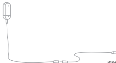
Abb. 1. Anschluss weiterer Kabelsensoren
