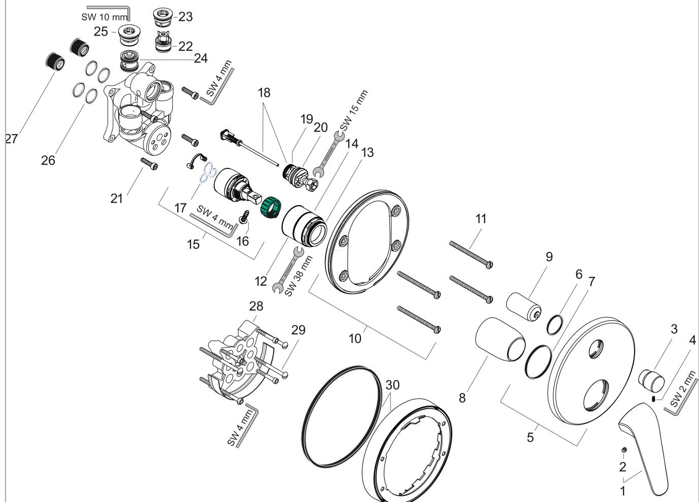
**Novus****Einhebel-Wannenmischer Unterputz mit integrierter Sicherungskombination nach EN1717 für
