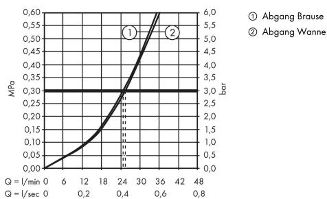
**Novus****Einhebel-Wannenmischer Unterputz mit integrierter Sicherungskombination nach EN1717 für
