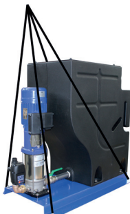
Fig. 13 Fastgørelse af løfteudstyr og transport
