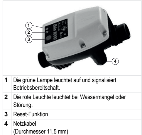
Abb. 10 Pumpensteuergerät (Außenbereich)
