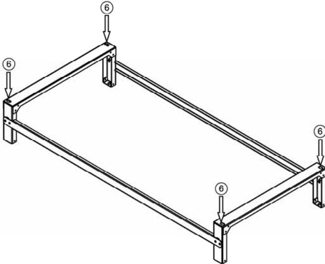
Abb. 4: Befestigungspunkte ⑥ für die Wärmepumpe
