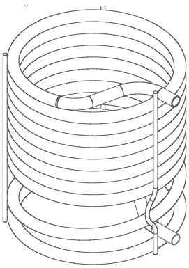
Bei der Nutzung des Zusatz-WT muss die Zulauf- und Speicher-Temperatur thermostatisch geregelt werden, um die Einhaltung der Temperatur-grenzen zu gewährleisten, wobei die Begrenzung der Speicher-temperatur Priorität genießt.
