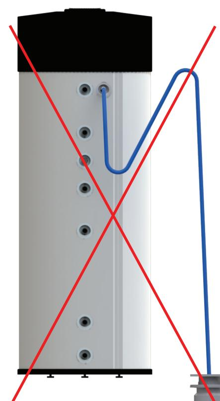
**!** Der Schlauch für den Kondensatablauf muss korrekt am Auslass montiert und in den Abfluss geführt werden. Wenn der Ablaufschlauch oberhalb des Kondensatablaufs geführt wird, kann das Kondensat in die BWWP zurückfließen. Schäden, die auf Grund dieses Montagefehlers entstehen sind von der Herstellergarantie ausgeschlossen
