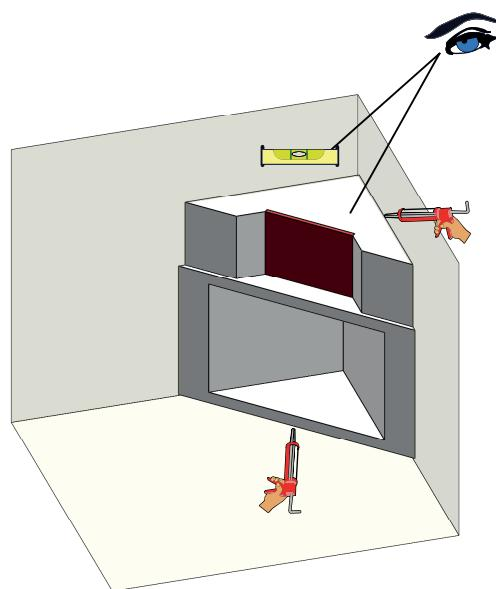
Armatur im Installationsschacht montieren und diesen mit der Verschlussplatte verschliessen. Verschlussplatte ist auch um 180° gedreht einsetzbar.
