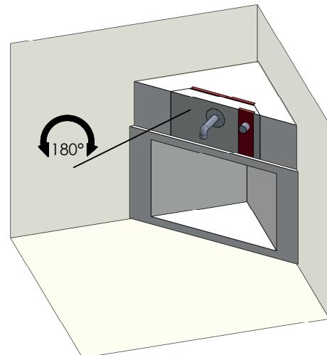
Wannenträger mit Montageschaum an Eckmodul und auf dem Boden mit Montagekleber/Montageschaum befestigen.
