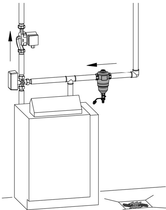
Abb. 4: Installationszeichnung Schlammabscheider
