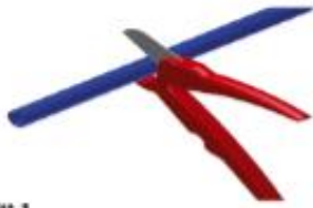
Schritt 1 Kunststoffrohr rechtwinklig abschneiden.
