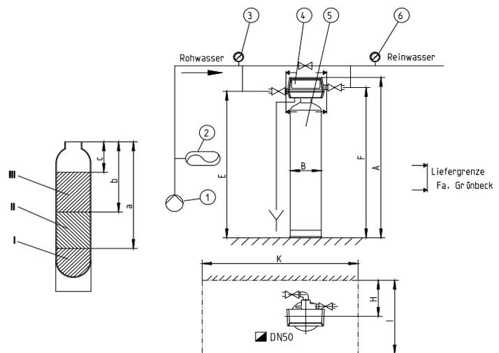
Abb. 2: Aufstellungszeichnung mit Fundamentplan
