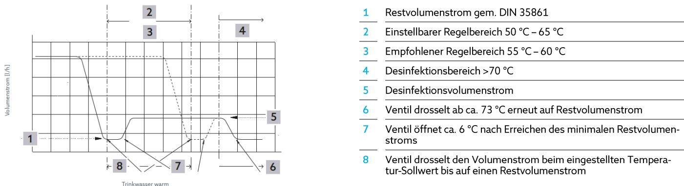
Das thermische Regelverhalten des Zirkulationsventils wird durch das abgebildete Diagramm beschrieben. Das Zirkulationsventil drosselt im normalen Betrieb (Temperaturbereich bis 60 °C) den Volumenstrom beim eingestellten Temperatur-Sollwert auf einen Restvolumenstrom.
