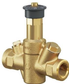
Für den hydraulischen Abgleich in Zirkulationsleitungen gemäß DVGW-Arbeitsblatt W551/W553. Die Aquastrom T Zirkulationsventile sind thermisch geregelt und mit Innen Gewinde verfügbar. Unterhalb der eingestellten Temperatur öffnet das Ventil und erhöht den Warmwasservolumenstrom selbsttätig. Das Ventil verfügt über einen festen Restvolumenstrom und erkennt eine thermische Desinfektion automatisch.
