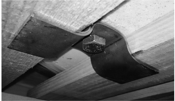
Abb. 20: Beispiel einer Befestigung (Transportsicherung) des Speichers unter der Palette
