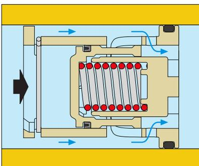
In diesem Arbeitsbereich drückt der Kolben die Feder vollständig zusammen und lässt das Medium nur durch die feststehende Öffnung durchfließen. Wie im ersten Fall wirkt der Kolben wie ein fester Regler. Die durch den AUTOFLOW® strömende Durchflussmenge hängt somit nur vom Differenzdruck ab.
