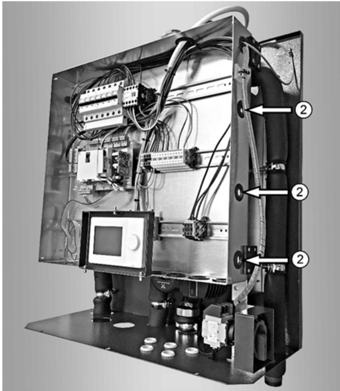
Abb. 17: Kabelführung zum Schaltfeld
