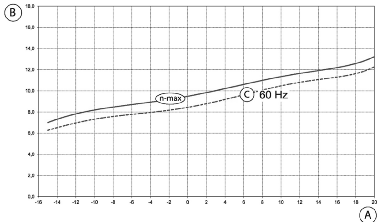
Abb. 59: Heizleistung ecoWP 15Xe bei Vorlauftemperatur 45°C
