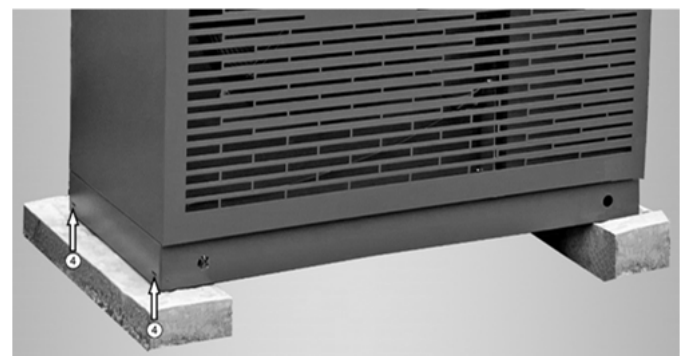
Abb. 6: Aufstellung auf Streifenfundament / Langlöcher ④ für Transportwinkel
