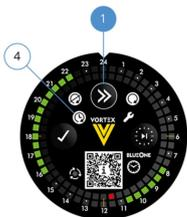
Nach Abschluss der Einstellungen die Weiter-Taste (1) drücken, um den Einstellmodus zu verlassen. LED-Anzeige Zeitschaltbetrieb (4) leuchtet. Die eingestellten Laufzeiten werden angezeigt.
