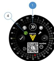
Weiter-Taste (1) drücken, um den Einstellmodus zu verlassen. LED-Anzeige Zeitschaltbetrieb (4) leuchtet. Die Uhrzeit und bereits eingestellte Laufzeiten werden angezeigt.
