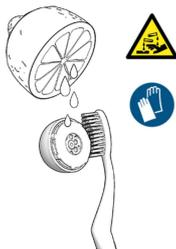
Rotor und Trennalotte mit Kalklösemittel von Kalk befreien. Rotor ggf. austauschen. Nur weiche, keine metallischen Hilfsmittel verwenden (z.B. Bürste, Tuch, Zahnstocher).
