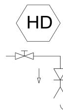
**Auslaufventil mit Systemtrenner, Sicherungseinrichtung BA**
