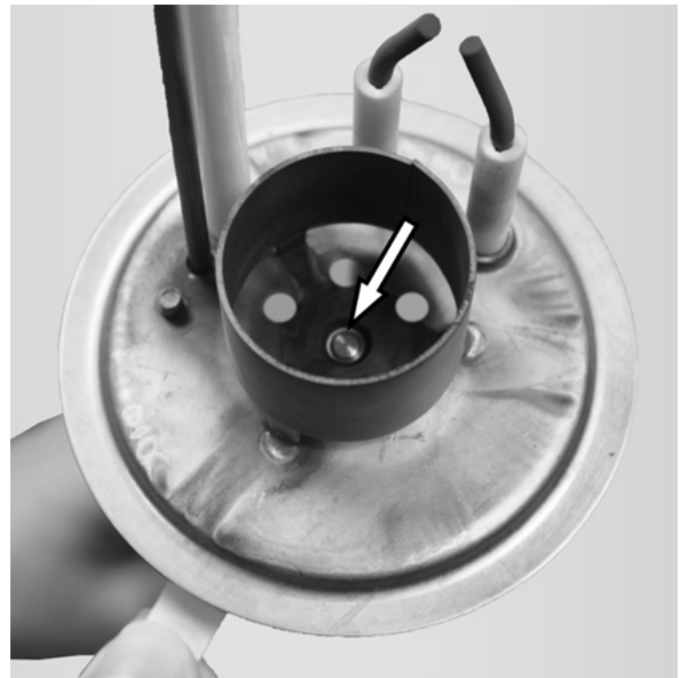
Abb. 17: Zentrierter Einstellstreifen zwischen Düsenkopf und Luftblende
