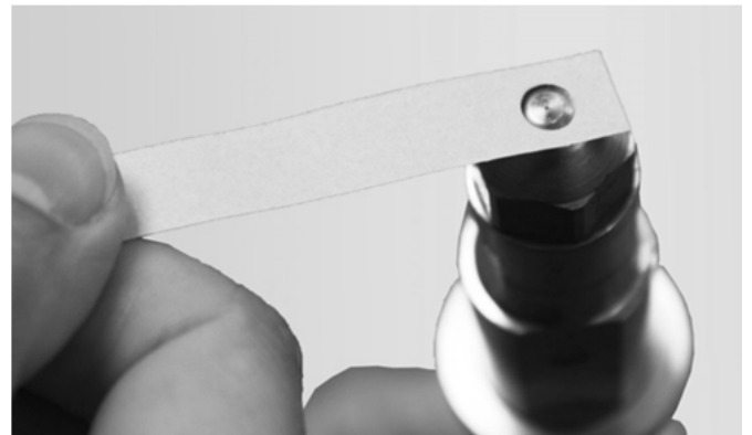
Abb. 16: Zentrierter Einstellstreifen auf dem Düsenkopf
