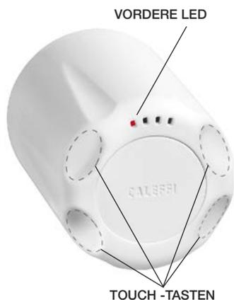
Die auf allen Heizkörperventilen montierten elektronischen Thermostatköpfe Art.Nr. 210510 sind zur Regelung der verschiedenen Zonen der Heizungsanlage unerlässlich. Durch Modulation der Durchflussmenge des Wärmeträgermediums regeln sie die Raumtemperatur abhängig von der gewählten Komfort-Stufe. Der Datenaustausch zwischen Zentraleinheit und elektronischem Thermostatkopf findet alle 10 Minuten statt (20 Minuten im Sommerbetrieb), um die Batterien zu schonen.
