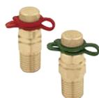
Satz druck-/Temperatur-messstutzen mit Schnellkupplung. Messing-Gehäuse. Dichtungen aus EPDM. Maximaler Betriebsdruck: 30 bar. Temperaturbereich: -5÷130°C. Anschlüsse: 1/4" AG.
