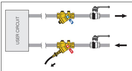
Effettuando un flussaggio inverso (il flusso d'acqua investe in senso opposto il filtro). Si chiude la valvola di intercettazione sulla mandata prima di aprire la valvola di scarico.
