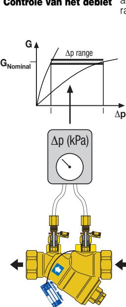
Date le caratteristiche dinamiche del dispositivo, è sufficiente verificare la pressione differenziale tra monte e valle, utilizzando le prese di pressione di cui è dotato.
