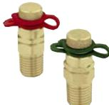
Le prese di pressione / temperatura possono essere montate sul corpo valvola per misurare la differenza di pressione tra monte e valle. I diversi colori evidenziano la pressione di monte (ROSSO) e quella di valle (VERDE).
