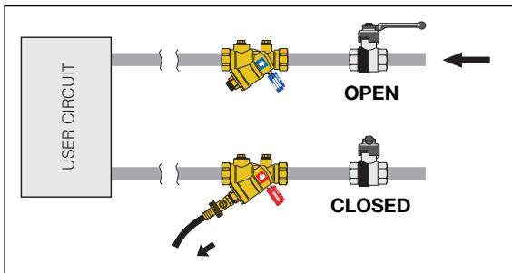
Para inverter o sentido do fluxo (o fluxo de água passa através do filtro no sentido inverso), fecha-se a válvula de intercepção na ida antes de abrir a válvula de descarga.
