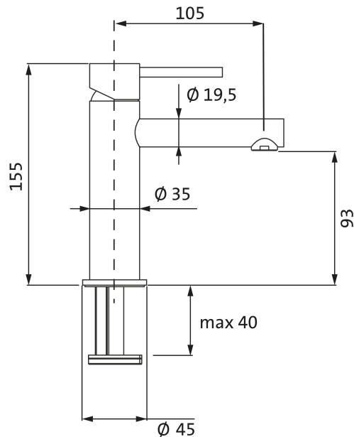
Lochbohrung  $\varnothing$  35 mm
