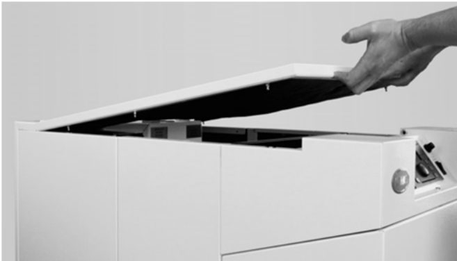
Abb. 42: Demontage der oberen Verkleidung
