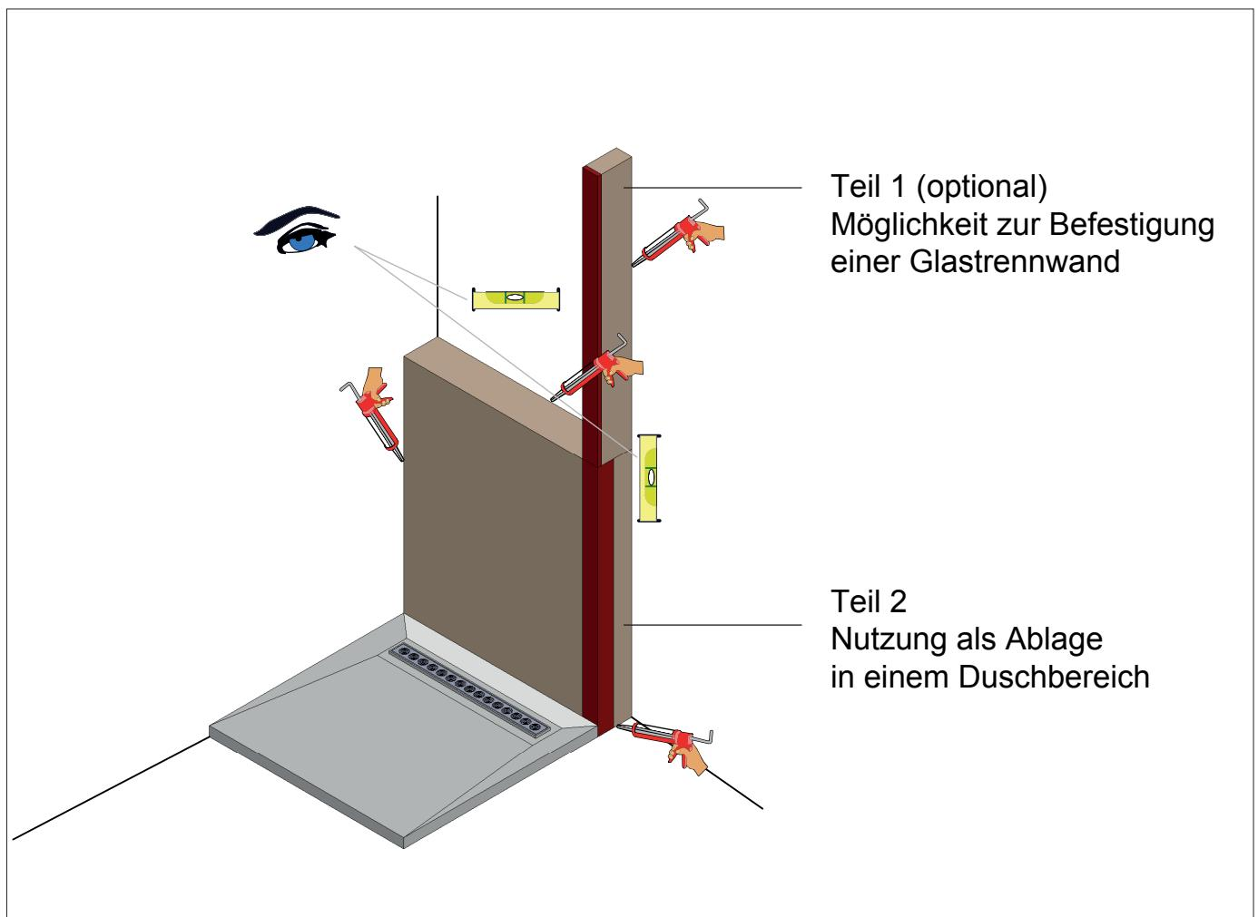
Wandmodul halbhoch wand- und bodenseitig mit beigefügtem Montagekleber befestigen
