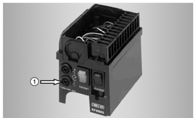
Abb. 29: Prüfsockel KF 8885 (Sach-Nr. 95.95215-0085) ① Messanschluss Lichtfühler
