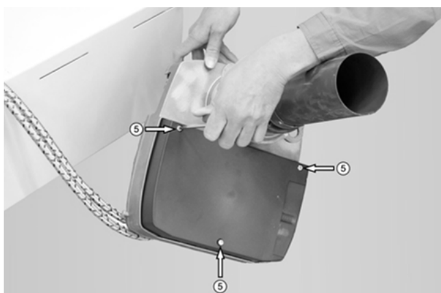
Fig. 2: Démontage du silencieux d'admission
