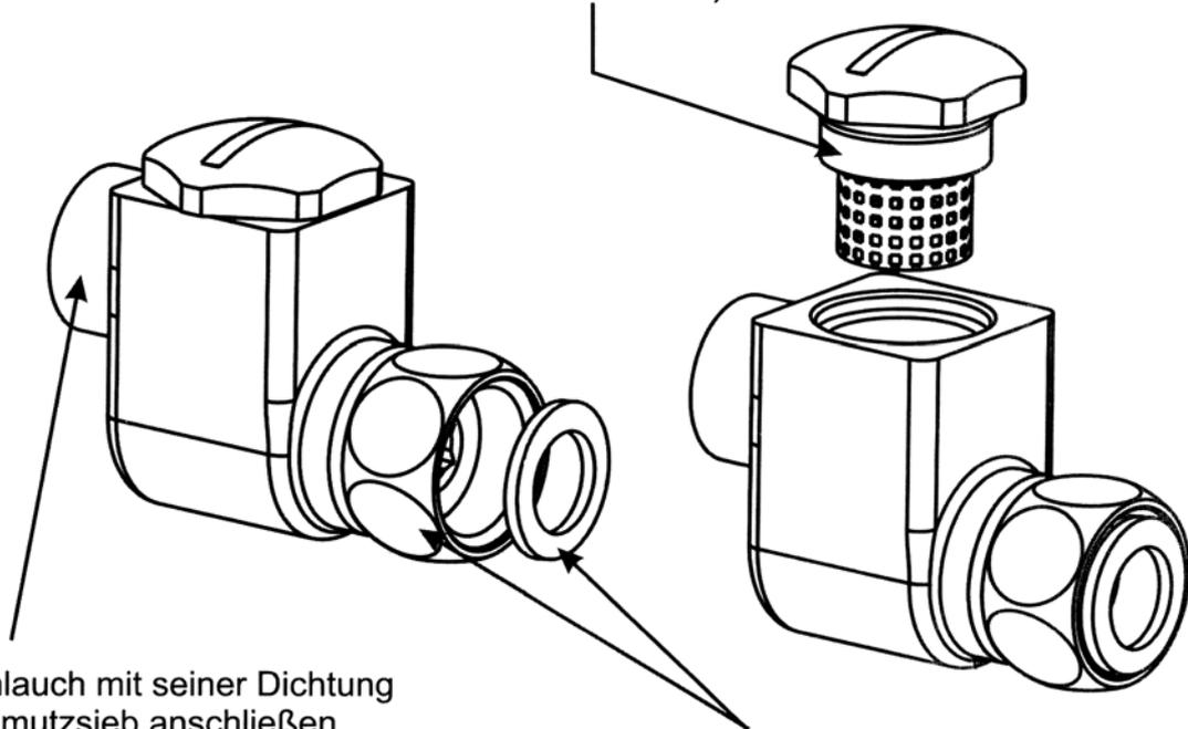
2. Flexschlauch mit seiner Dichtung an Schmutzsieb anschließen.
