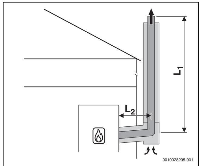
Bild 12 Konzentrische Luft-Abgas-Führung nach C<sub>53x</sub> an der Außenwand
