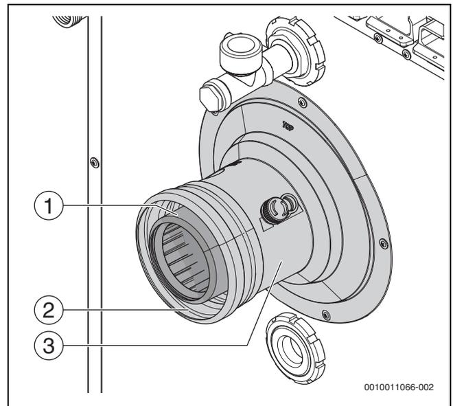
Bild 15 Abgasanschluss montieren
