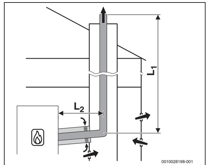
Bild 19 Starre Abgasführung im Schacht nach B<sub>33</sub> mit raumluftabhängiger Luftzufuhr über die konzentrische Luft-Abgas-Führung im Aufstellraum
