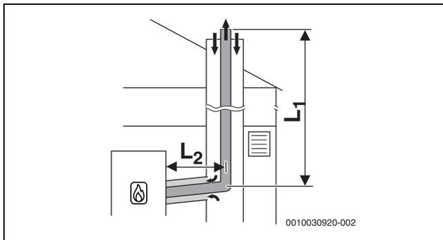
Bild 13 Starre Abgasführung nach C<sub>93x</sub> im Schacht und konzentrische Luft-Abgas-Führung im Aufstellraum
