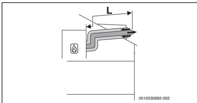
Bild 6 Horizontale konzentrische Luft-Abgas-Führung nach C<sub>13x</sub> über das Dach
