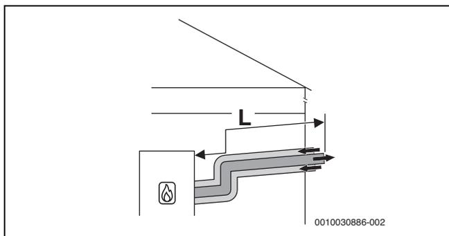
Bild 7 Horizontale konzentrische Luft-Abgas-Führung nach C<sub>13x</sub> durch die Außenwand
