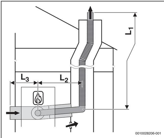
Bild 11 Flexible Abgasführung nach C<sub>53x</sub> im Schacht und Luft-Abgas-Führung mit separater Luftzufuhr und konzentrischer Abgasableitung im Aufstellraum
