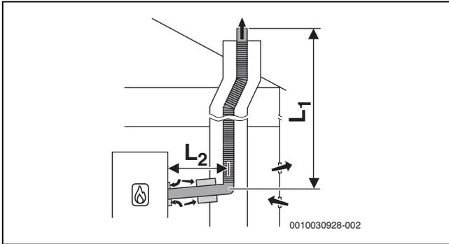
Bild 18 Flexible Abgasführung im Schacht nach B<sub>53p</sub> mit raumluftabhängiger Luftzufuhr am Wärmeerzeuger und konzentrischem Verbindungsstück zwischen Aufstellraum und Schacht
