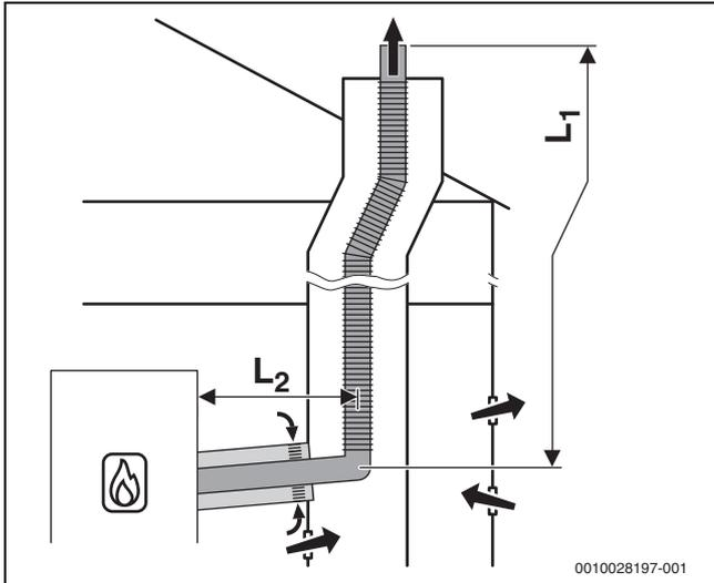
Bild 20 Flexible Abgasführung im Schacht nach B<sub>33</sub> mit raumluftabhängiger Luftzufuhr über die konzentrische Luft-Abgas-Führung im Aufstellraum
