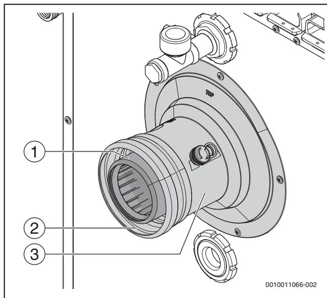
Bild 16 Abgasanschluss montieren
