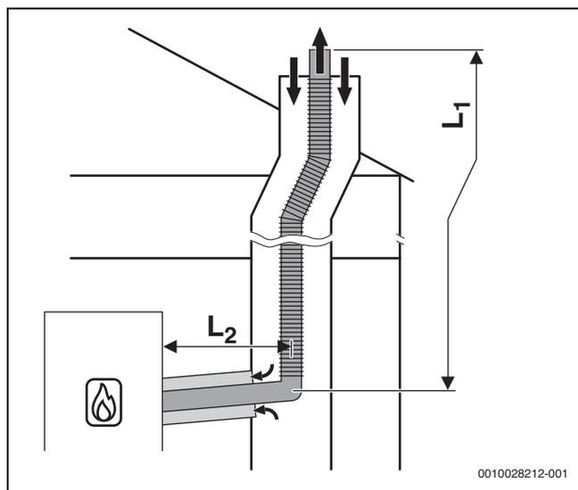
Bild 14 Flexible Abgasführung nach C<sub>93x</sub> im Schacht und konzentrische Luft-Abgas-Führung im Aufstellraum
