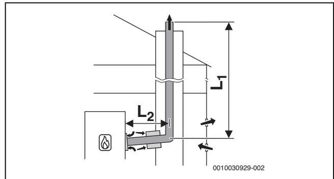
Bild 17 Starre Abgasführung im Schacht nach B<sub>53P</sub> mit raumluftabhängiger Luftzufuhr am Wärmeerzeuger und konzentrischem Verbindungsstück zwischen Aufstellraum und Schacht
