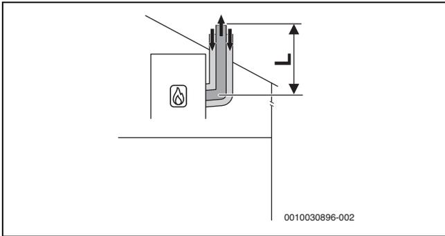
Bild 9 Vertikale konzentrische Luft-Abgas-Führung nach C<sub>33x</sub>
