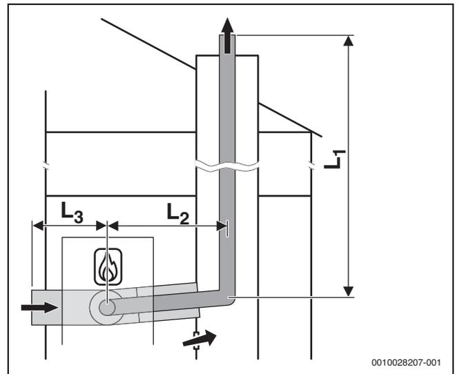
Bild 10 Starre Abgasführung nach C<sub>53x</sub> im Schacht und Luft-Abgas-Führung mit separater Luftzufuhr und konzentrischer Abgasableitung im Aufstellraum
