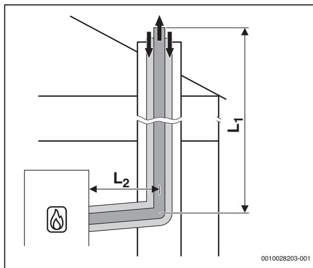
Bild 8 Konzentrische Luft-Abgas-Führung nach C<sub>33x</sub> im Schacht
